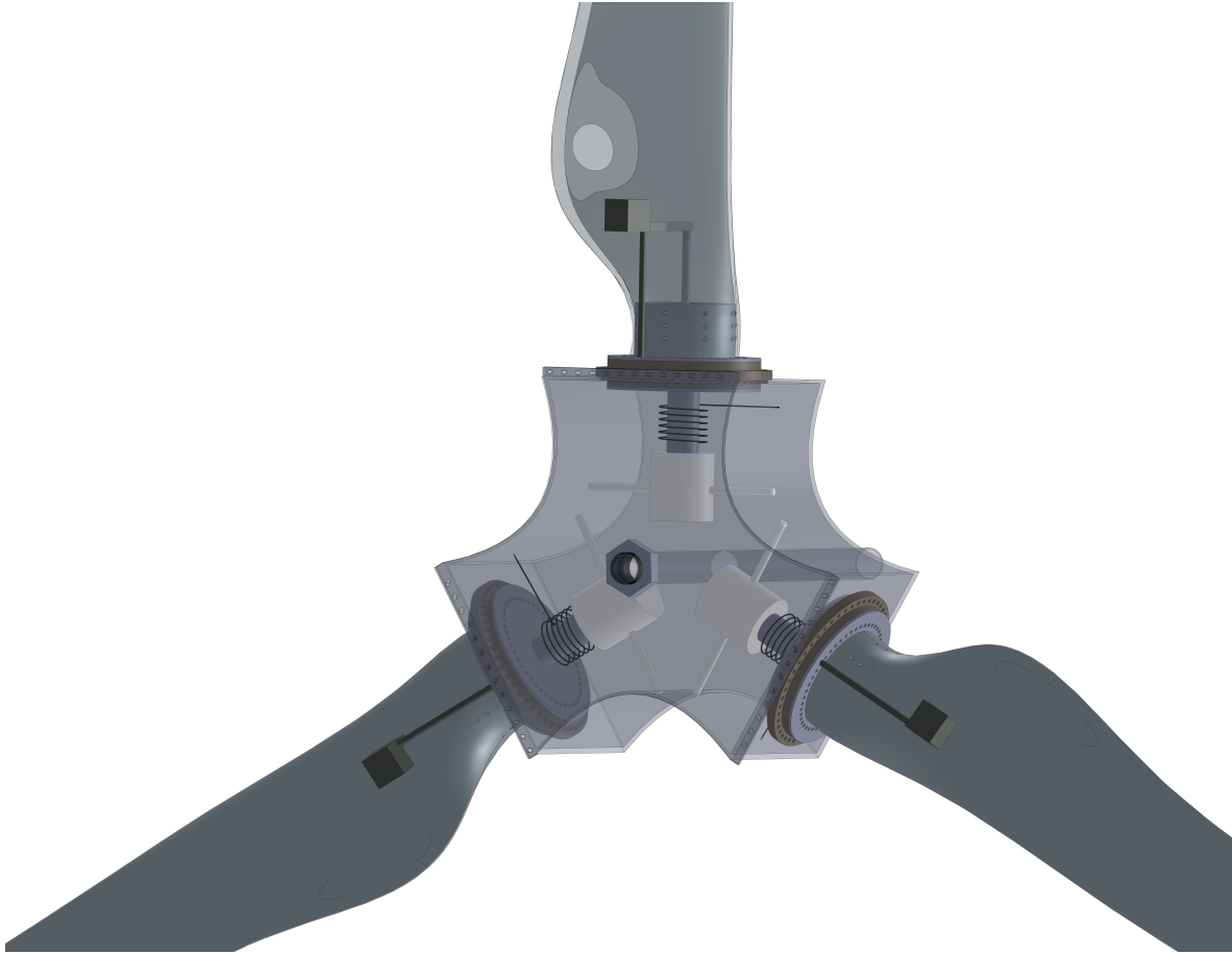
Fig. 5.29. Diagrama CAD del sistema de control pasivo.
